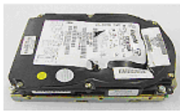
破壊処理後本体に穴が開いています
